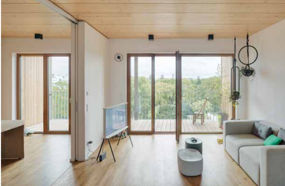
Flexible Grundrisse: Innerhalb der tragenden Wände in vorgefertigter Holzrahmenbauweise konnten die BewohnerInnen ihre Einheiten mit Trockenbauwänden frei gestalten
