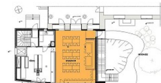
Grundriss Erdgeschoss mit Anschluss zum Bestandsbau (oben), dessen Treppenhaus die Etagen des Neubaus erschließt.
